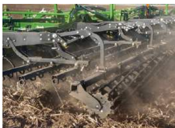
3-рядная штригельная борона с пружинным прикатывающим катком
