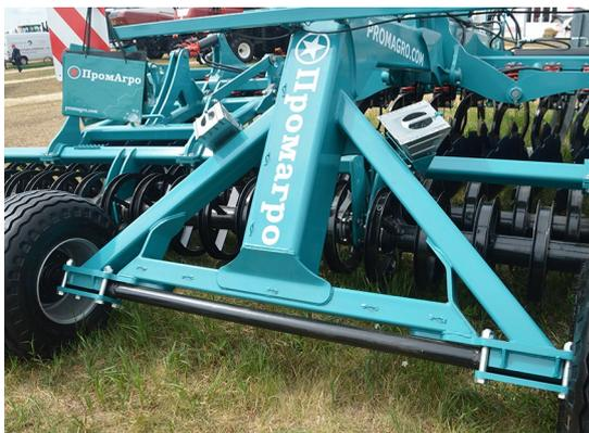
Широкая, усиленная **ходовая тележка** со световыми приборами обеспечивает безопасные перегоны. Она может быть оснащена пневматической тормозной системой с ручным стояночным тормозом и противооткатными башмаками.
