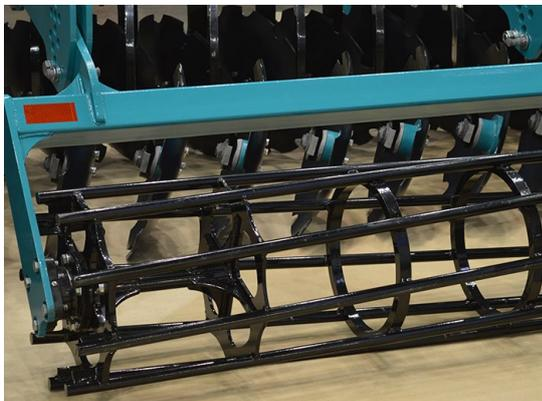
**Прутковый каток** выполнен без центрального вала, устойчив к забиванию, широко универсален. Диаметр катка 500 мм.
