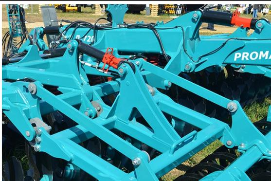
**Регулировка глубины обработки заднего ряда дисков** выполнена с помощью гидроцилиндров установленных на рамках катков.
