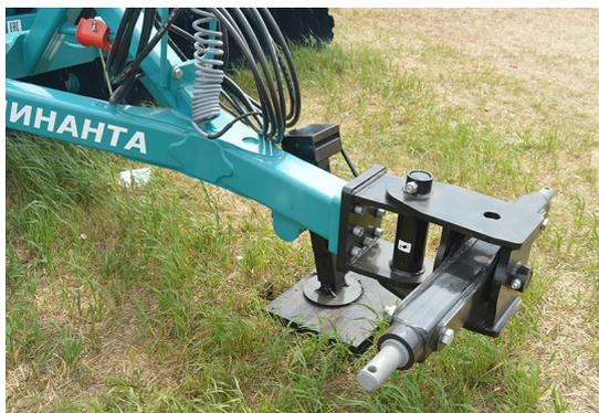
Усиленная **треугольная сница со сменной серьгой** обеспечивает высокую маневренность агрегата при поворотах. Возможна комплектация поперечной планкой для **трехточечной навески** трактора 3 и 4 класса.
