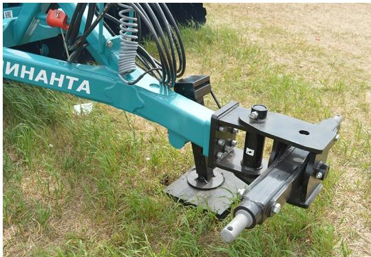
Усиленная **треугольная сница со сменной сергой** обеспечивает высокую маневренность агрегата при поворотах. Возможна комплектация поперечной планкой для **трехточечной навески** трактора 3 и 4 класса.
