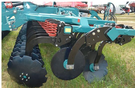
**Рабочий орган:** необслуживаемый пружинный блок, стойка из качественной легированной высокоуглеродистой стали, необслуживаемый режущий узел, диск диаметром 610 мм.
