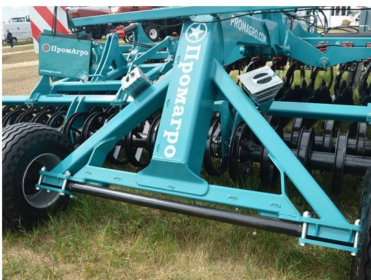
Широкая, усиленная **ходовая тележка** со световыми приборами и противооткатными башмаками обеспечивает безопасные перегоны. Она может быть оснащена пневматической тормозной системой с ручным стояночным тормозом.
