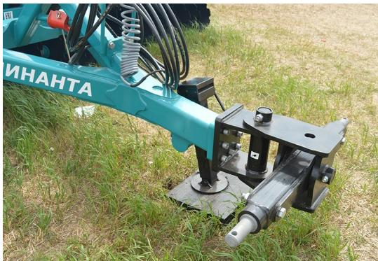
Усиленная треугольная сница со сменной серьгой обеспечивает высокую маневренность агрегата при поворотах.
