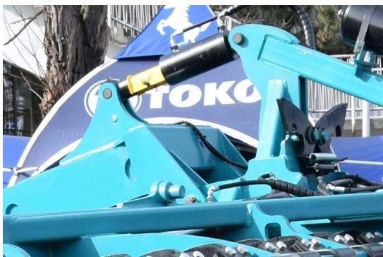
**Регулировка глубины обработки** выполнена в виде клипс, расположенных на гидроцилиндрах. Это позволяет быстро и качественно настроить агрегат на глубину до 18 см. Взамен клипс для транспортировки устанавливается транспортный упор.
