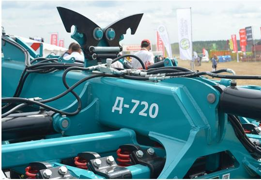
Автоматическое стопорение рамы управляется гидравликой из кабины трактора при складывания и раскладывания бороны.
