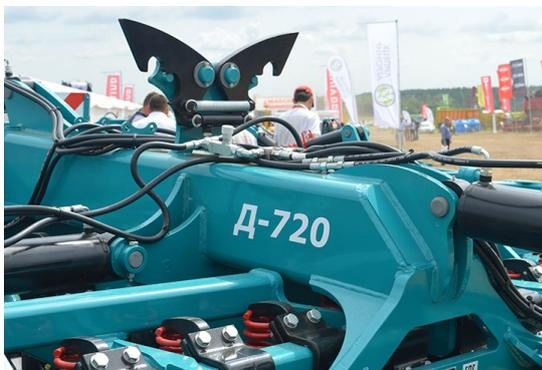
**Автоматическое стопорение рамы** управляется гидравликой из кабины трактора для складывания и раскладывания бороны.
