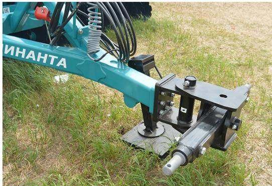
Усиленная **треугольная сница со сменной серьгой** обеспечивает высокую маневренность агрегата при поворотах. Возможна комплектация поперечной планкой для **трехточечной навески** трактора 3 и 4 класса.
