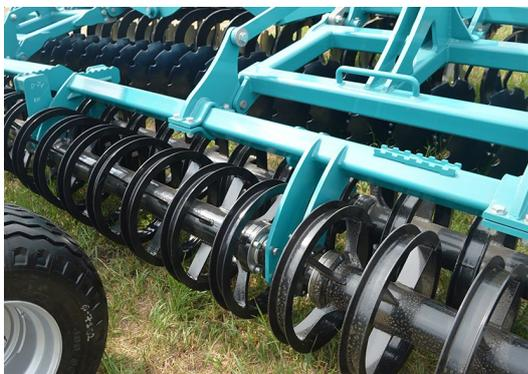
**Тяжелый тандемный каток** за счет самоочистки не забивается на влажных почвах. Разрушает комья почвы, производит окончательное обратное уплотнение и выравнивание почвы.
