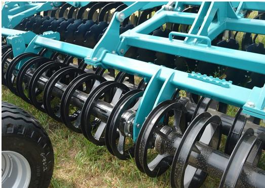
**Тяжелый tandemный каток** за счет самоочистки не забивается на влажных почвах. Разрушает комья почвы, производит окончательное обратное уплотнение и выравнивание почвы.
