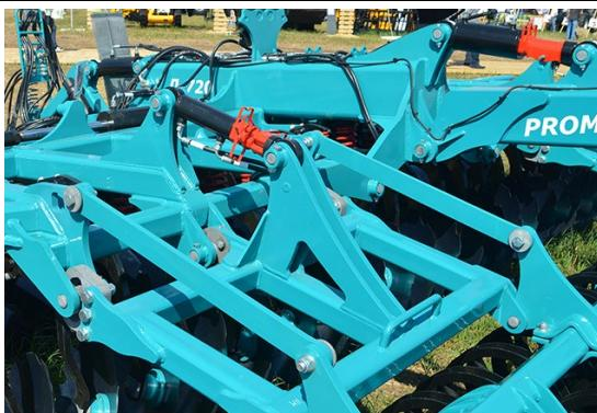
**Регулировка глубины обработки заднего ряда дисков** выполнена с помощью гидроцилиндров установленных на рамках катков.
