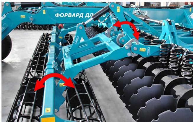
Система поперечного копирования тандемного катка расположенного на шарнирной подвеске, позволяет снизить нагрузку на раму при работе по неровным полям и улучшает копирование почвы всем агрегатом.
