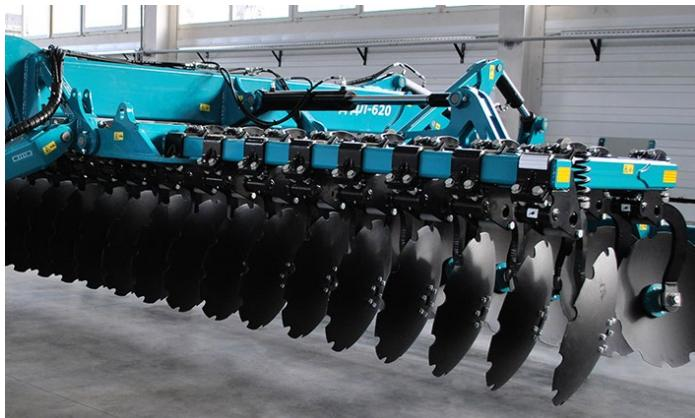
Регулировка горизонтального положения боковых рам осуществляется с помощью регулируемых шарниров гидроцилиндра.
