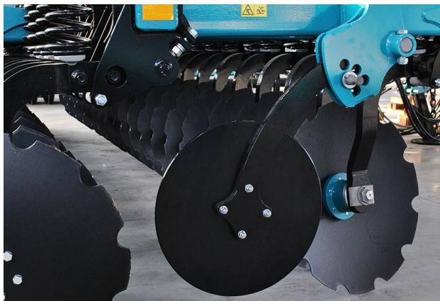
Отбойник предотвращает выброс почвы на необработанные участки почвы.
