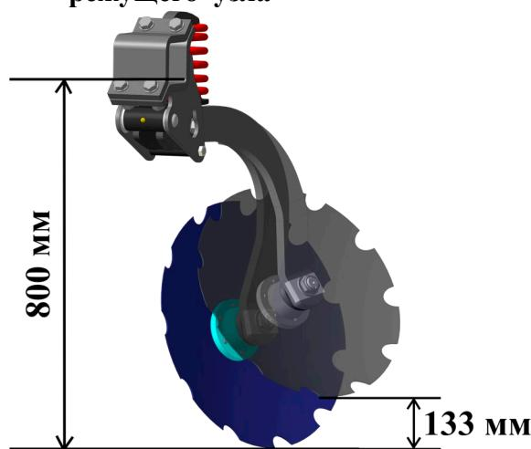
Защитное вертикальное смещение стойки 133 мм.
