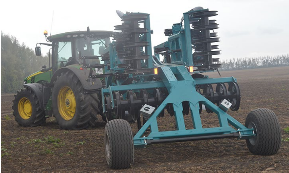
Рабочий орган культиватора с комплектом MulchMix
