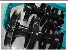
Шахматное расположение колец **тяжелого тандемного катка с U-образным профилем** хорошо влияет на самоочищение. Основательно прикатывает. Стабилизирует работу агрегата по глубине на счет эффекта самоочищения.
