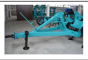
**Усиленная треугольная сница** со сменной серьгой обеспечивает высокую маневренность агрегата при поворотах. Возможна комплектация поперечной планкой для трехточечной навески трактора категории 3 и 4.
