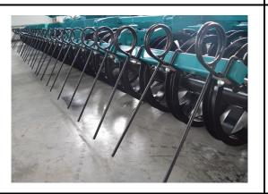
Расширенные регулировки скребниц: угол наклона, угол атаки и общее положение бороны относительно почвы. Скребницы служат для оптимального распределения соломы, выравнивания и крошения структуры почвы.
