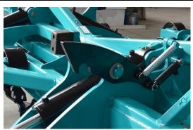
**Автоматическое стопорение** рамы управляется гидравликой, нет необходимости выхода водителя из кабины.
