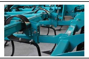
Простая и быстрая настройка глубины обработки за счет пальцев на опорном прикатывающем катке.
