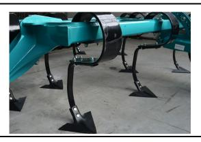
**Вибро-стойки** долговечны и устойчивы к ударам и камнм. Не требуют технического обслуживания. благодаря своей постоянной вибрации лучше разрушаются комья почвы.
