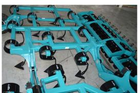
**Конструкция рамы** мощная и жесткая. Выполнена из трубы 100x100x10 мм. Боковые рамы копируют контур почвы.
