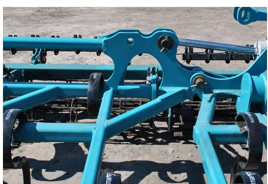
**Конструкция рамы** мощная и жесткая, усиленная накладками. Боковые крылья крепятся к усиленным силовым местам. Балки расположены в двух уровнях.
