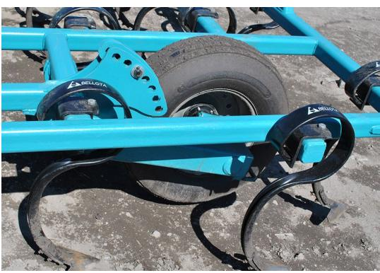
При помощи **боковых опорных колес** происходит быстрая и легкая настройка глубины обработки боковых рам культиватора.
