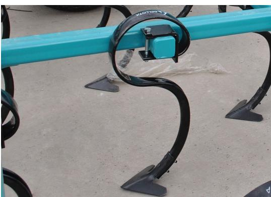
**Вибро-стойки** долговечны и устойчивы к ударам и камням, не требуют технического обслуживания и не забиваются, благодаря своей постоянной вибрации. Сечение стойки 70 x 12 мм.
