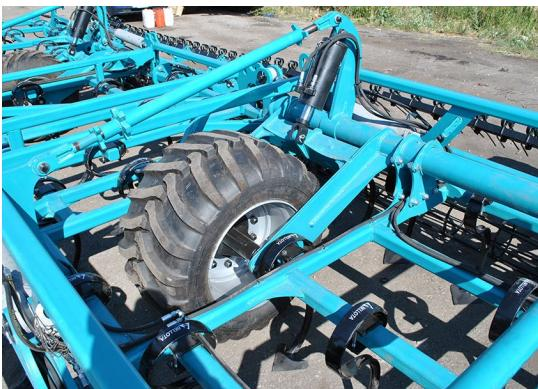
**Система стабилизации и копирования рельефа** обеспечивает копирование неровности почвы каждой секцией рамы. При изменении глубины обработки плоскость рамы всегда остается параллельной поверхности почвы. Система позволяет проводить равномерную по глубине обработку почвы всеми органами культиватора, что дополнительно выравнивает поверхность поля.
