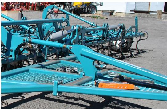
**Усиленная треугольная сница со сменной серьгой для различных прицепных устройств трактора категории 3 и 4.**
