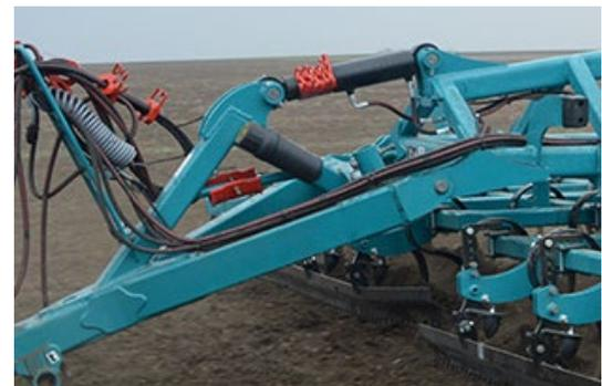
**Регулировка глубины обработки** выполнена в виде клипс, расположенных на гидроцилиндрах. Это позволяет быстро и качественно настроить агрегат на глубину до 12 см.
