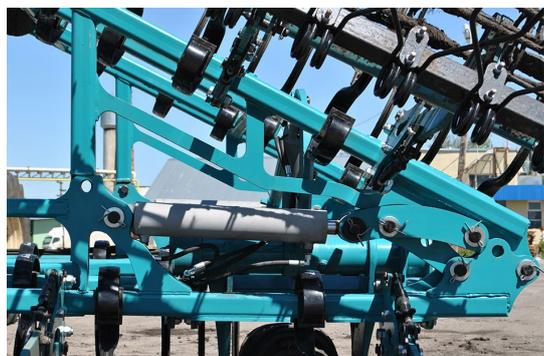
**Гидравлическая система складывания** с надежным стопорением в транспортном положении.
