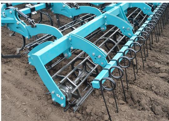
**Прутки тандемного катка** расположены под углом к оси вращения, что обеспечивает постоянный контакт катка с почвой, плавность движения и устойчивость к забиванию. Бороны скребницы дополнительно вычесывают сорные растения.
