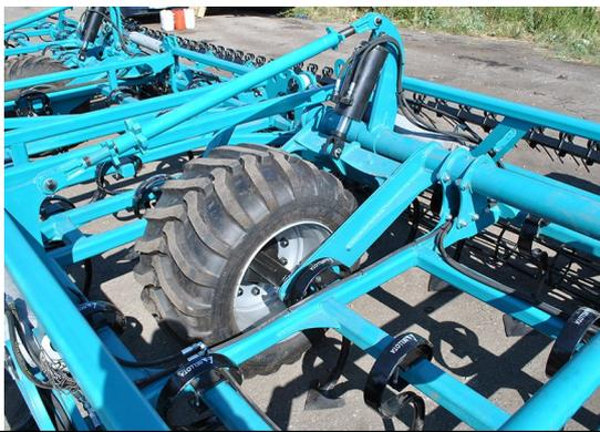
**Система стабилизации и копирования рельефа** обеспечивает копирование неровности почвы каждой секцией рамы. При изменении глубины обработки плоскость рамы всегда остается параллельной поверхности почвы. Система позволяет проводить равномерную по глубине обработку почвы всеми органами культиватора, что дополнительно выравнивает поверхность поля.
