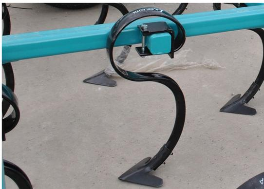
**Вибро-стойки** долговечны и устойчивы к ударам и камням, не требуют технического обслуживания и не забиваются, благодаря своей постоянной вибрации. Сечение стойки 70 x 12 мм.
