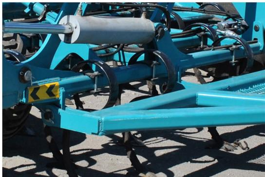
Прочный и надежный **узел крепления сницы к раме** силовыми листами толщиной 25 мм позволяет равномерно распределить тяговые усилия на всю конструкцию рамы.
