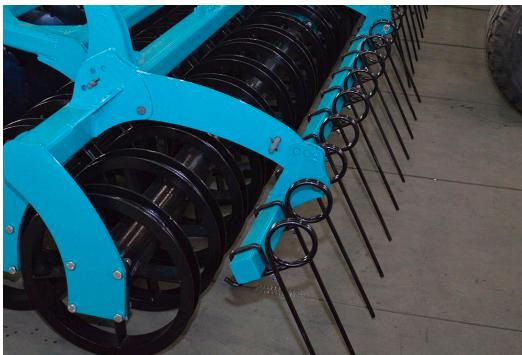
**Тяжелый тандемный каток с У-образными кольцами** устойчив на каменистой поверхности, что делает его универсально применимым на всех типах почвы. Положения катков относительно рамы регулируется гидроцилиндрами, это многократно увеличивает скорость настройки глубины обработки.
