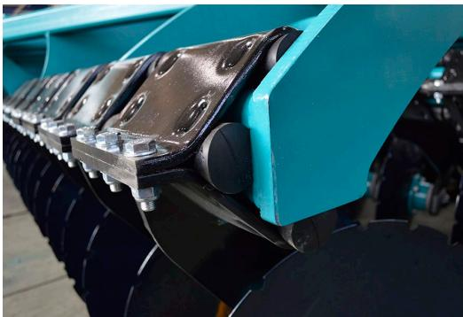
**Индивидуальное крепление рабочих органов** к раме посредством эластичных резиновых демпферов 50 мм, выполнено на балке с сечением 100 x 100 мм. Это продлевает срок службы агрегата и позволяет копировать поверхность почвы, также служит в качестве предохранительного механизма при встрече с камнями.
