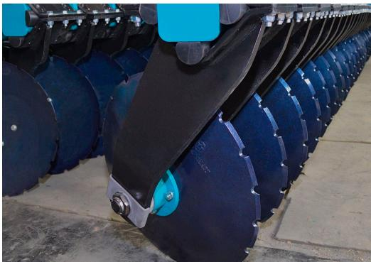
**Необслуживаемый режущий узел** не требующий технического обслуживания. На агрегате возможна установка гладких дисков для точной поверхностной обработки стерни или дисков с мелкими вырезами для заделки большого количества соломы и растительных остатков.
