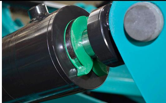
**Регулировка глубины обработки** выполнена в виде клипс, расположенных на гидроцилиндрах. Это позволяет быстро и качественно настроить агрегат на глубину от 3 до 15 см.
