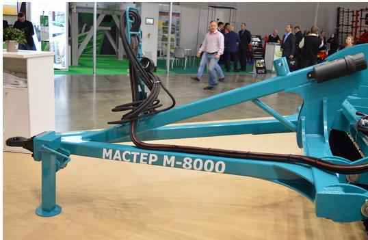
Усиленная узкая сница со сменной серьгой обеспечивает высокую маневренность агрегата при поворотах. Возможна комплектация поперечной планкой для трехточечной навески трактора 3 и 4 класса.
