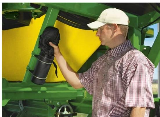
Этот мешок позволяет легко собирать образцы семян или удобрений для калибровки. Он плотно облегает нижнюю часть камеры коллектора, не пропуская ни одного семечка. Его удобно хранить в любом прочном контейнере или в новом большом инструментальном ящике (модель объемом 19 381 л). В обоих случаях имеется надежное крепление к раме.
