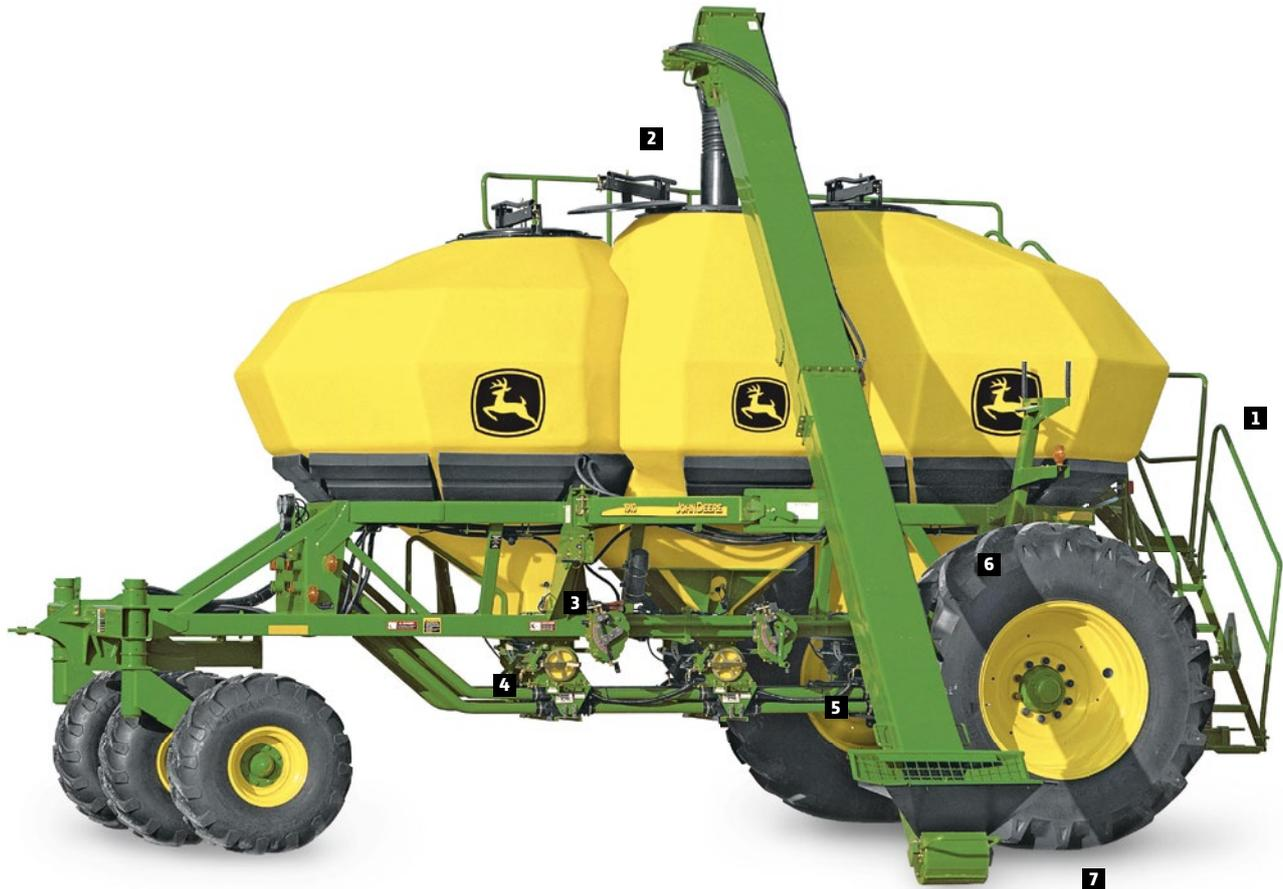
**1** | Удобная лестница ведет к устойчивой платформе. Крышки бункера удобно расположены на расстоянии вытянутой руки. Расстояние между центрами крышек составляет всего 1,5 м, что позволяет с лёгкостью изменять положение конвейера.
