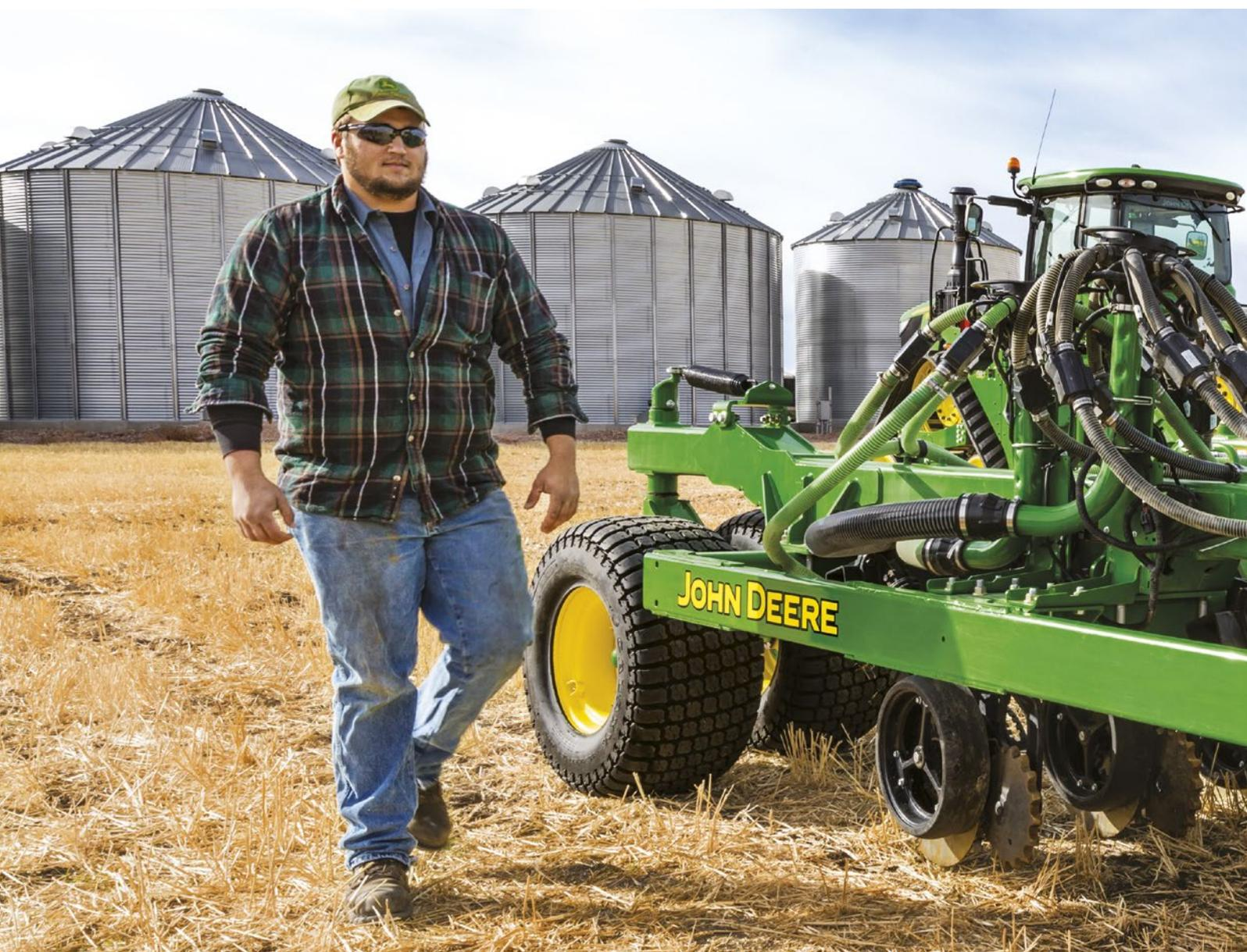
Точное размещение семян также превзойдет Ваши ожидания. Увеличенные шины главной рамы и боковых секций улучшают проходимость и уменьшают уплотнение почвы для обеспечения одинаковой глубины посева и улучшения контакта семян с почвой. А при работе на холмистых полях секции рамы изгибаются для копирования рельефа грунта.
