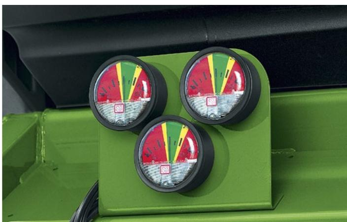
Индикаторы положения крышек покажут, плотно ли закрыты крышки бункеров. Цветной датчик для каждого бункера позволяет определить, можно ли начать работу дозирующей системы.
