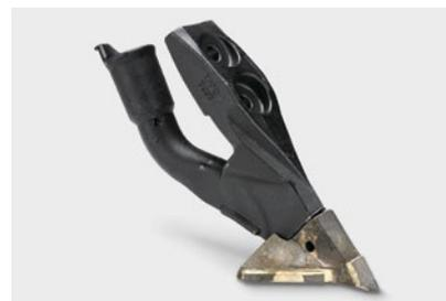
Опции сошников: влажность почвы можно сохранить благодаря ножам с наконечниками для минимального повреждения почвенного слоя. Эти износостойкие карбидные наконечники имеют ширину 2,5 или 10 см. Сошники и стрелчатые лапы Perma-Loc заменяются в пять раз быстрее, чем обычные компоненты на болтах, сокращая время и затраты на сервисное обслуживание.
