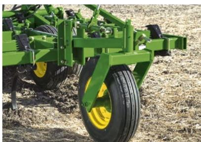
**Передняя ось качающегося балансира и стабилизирующие колеса** обеспечивают высокую прочность передней рамы и выравнивание передней и задней части машины для наилучшего копирования рельефа по направлению движения. Стабилизирующие колеса могут свободно вращаться для оптимального посева на криволинейных участках превосходным повторением контура без риска повреждений.
