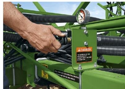
**Запатентованная активная гидравлическая система:** (ниже) просто задайте прижимное усилие (до 48 кг на сошник), чтобы создать борозду и получить необходимое уплотнение почвы над семенами.
