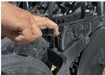
**Чтобы своевременного отслеживать забивания** при посеве, установите датчики контроля забивания семян. Для системы контроля забивания первичных семяпроводов датчик устанавливается в один из семяпроводов на каждой башне. В системе забивания всех семяпроводов – на каждый вторичный семяпровод.
