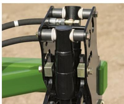
**Гидравлическая система** использует азотные аккумуляторы для управления стойками для внесения удобрений и прижимным усилием прикатывающих колес. Данная система работает независимо от трактора, так что не требуется непрерывный поток масла и мощность трактора не снижается.
