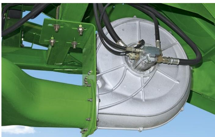
Гидравлический мотор приводит во вращение большой вентилятор диаметром 45 см. Вентилятор перемещает до 570 кг/га, используя большой объем воздуха при более низких скоростях, что сводит к минимуму повреждение семян.
