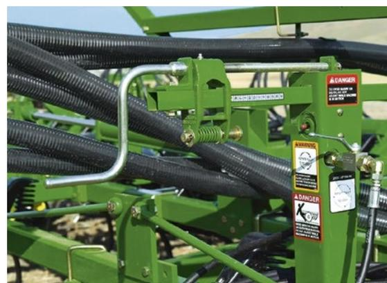
Простые в использовании системы **одноточечного контроля глубины** входят в стандартную комплектацию всех пневматических сеялок 730. Клапан и рычаг системы устанавливаются непосредственно на цилиндрические штифты для точного контроля глубины. Диапазон хода сошника составляет от 51 мм над землей до 127 мм в глубину с шагом 3 мм на оборот, что позволяет изменить рабочую глубину за считанные секунды и значительно увеличивает время бесперебойной работы.
