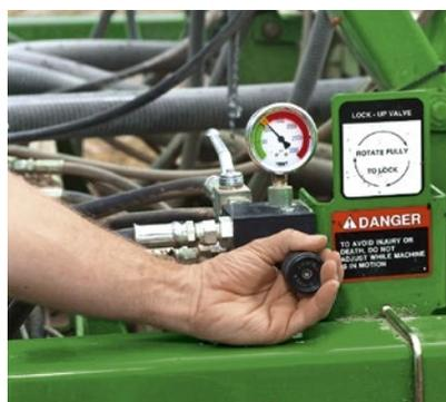
**Запатентованная гидравлическая система активного заглубления** устанавливает прижимное усилие до 181 кг на сошник для стабильной производительности в любых условиях.
