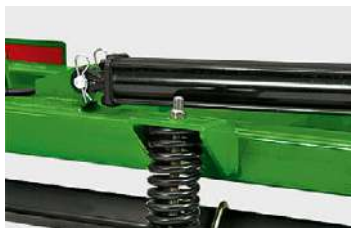
Прочная центральная рама увеличивает прижимное усилие для выравнивания поверхности поля и обеспечения идеального уплотнения почвы.
