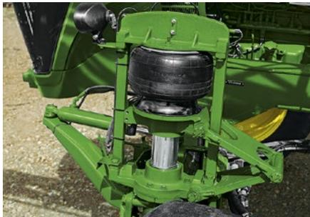
Длина хода подвески до 20 см обеспечивает стабильность опрыскивателя и комфорт для оператора.
