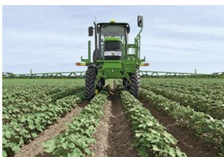
Функция гидравлической регулировки колеи позволяет настраивать ширину колеи в диапазоне от 3,05 до 3,86 м для соответствия различным междурядьям или технологической колее.
