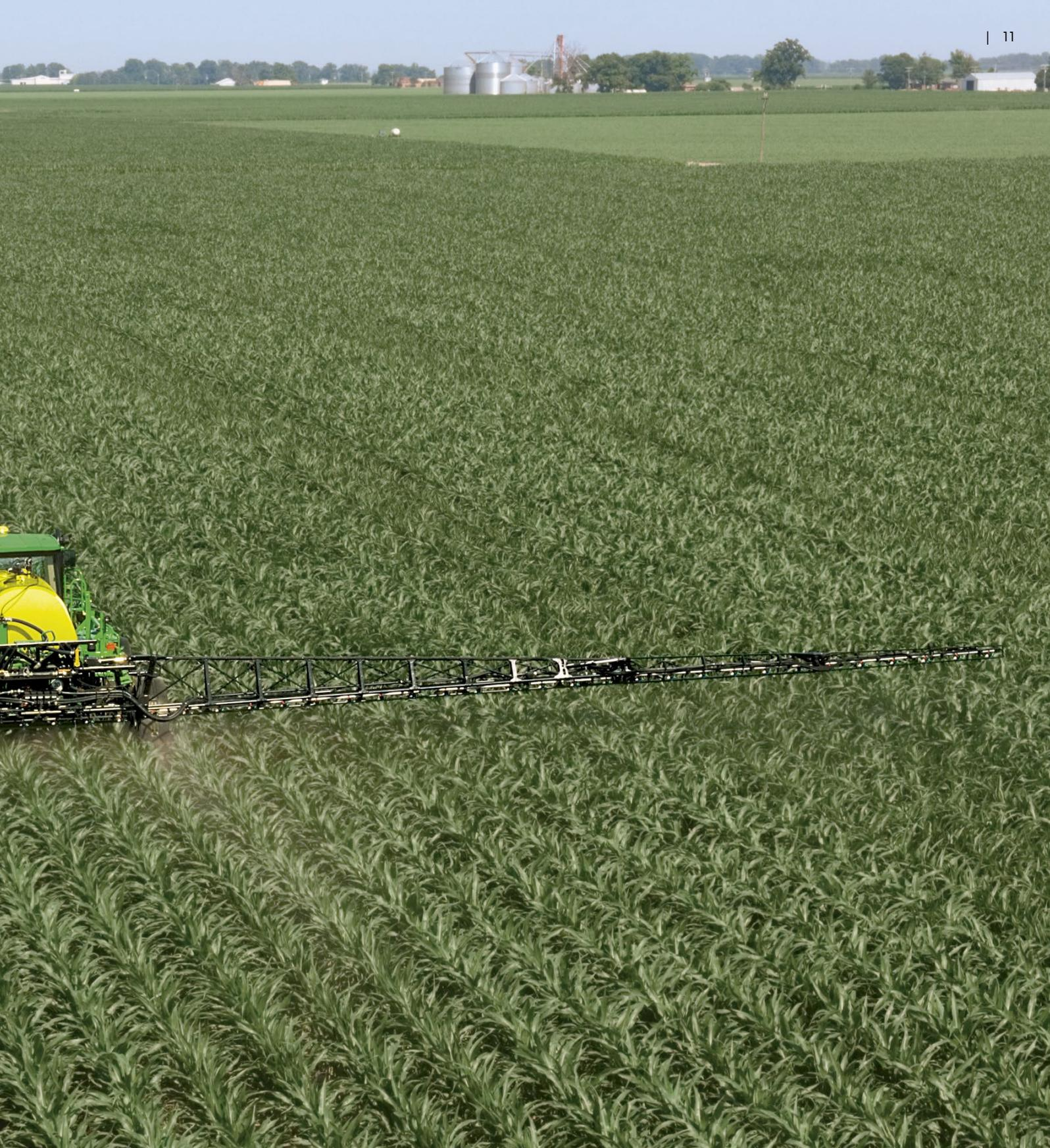
Входящие в стандартную комплектацию складные крайние секции помогают защитить штангу при столкновении с препятствиями. Складная секция штанги сохраняет геометрию при опрыскивании, но при ударе о препятствие секция отклоняется назад, чтобы предотвратить серьезное повреждение. Далее смещенная секция автоматически возвращается в исходное положение.
