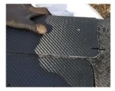
Новые секции из углеродного волокна, которые входят в состав ремонтного комплекта, точно соответствуют размеру поврежденной секции штанги.
