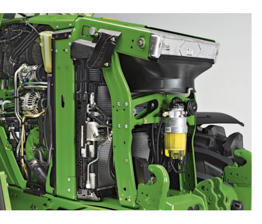
Инновационная конструкция охладителя воздуха турбонаддува позволяет его вентилятору работать со скоростью, отличающейся от скорости основного вентилятора, что еще больше повышает эффективность использования топлива.
