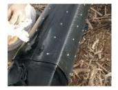
После фиксации новых слоев углеродного волокна с помощью клея и заклепок отремонтированная штанга не уступает по прочности новой.
