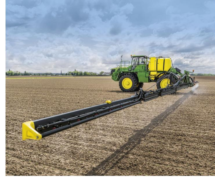
PowrSpray — уникальная двухконтурная система с кнопочными элементами управления, обеспечивающая быстрое и эффективное заполнение, перемешивание и опрыскивание.
