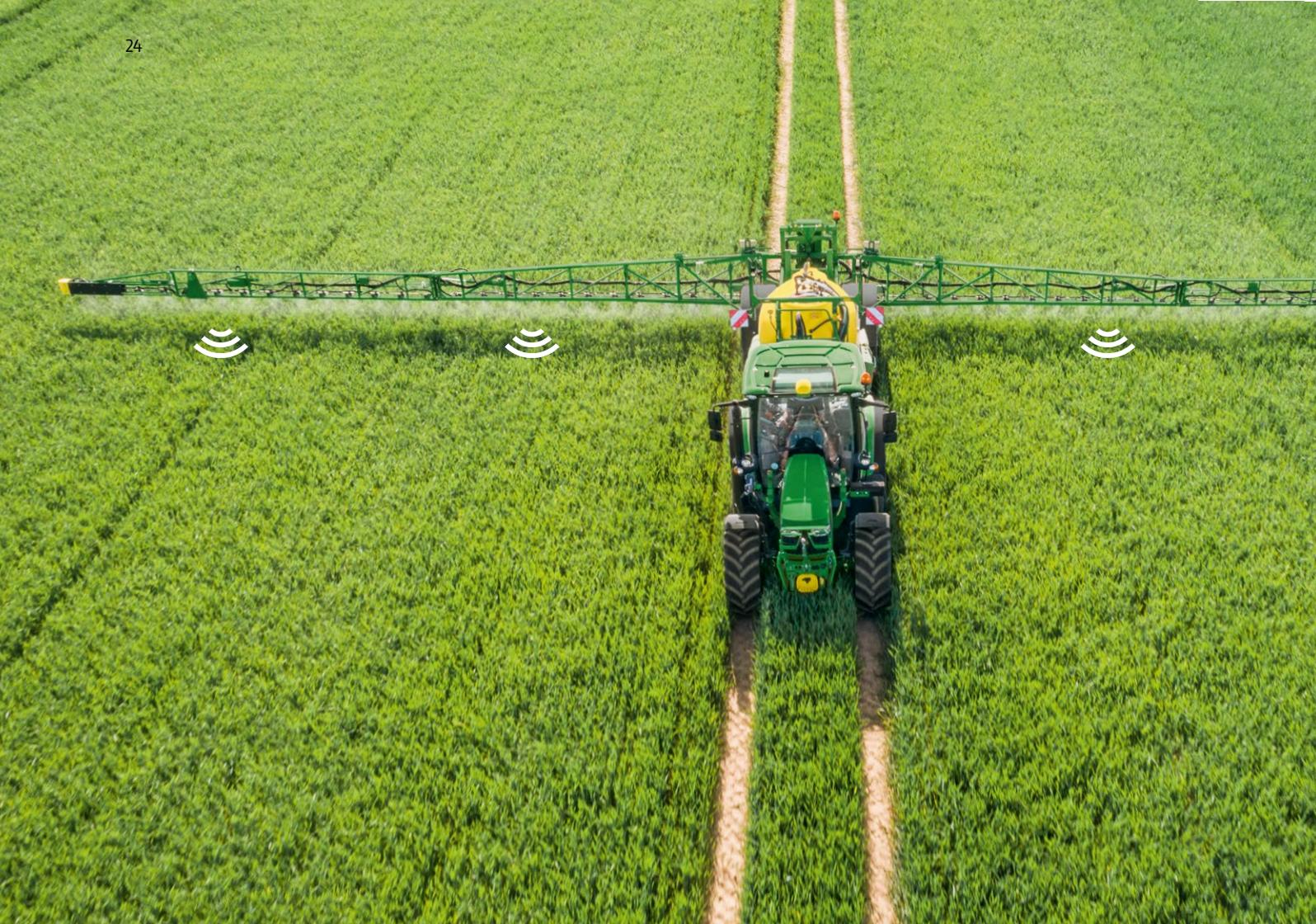
Используя показания двух или четырех ультразвуковых датчиков, система TerrainControl Pro автоматически управляет наклоном и высотой штанги, поддерживая постоянную высоту опрыскивания, что позволяет снизить снос, увеличить скорость и уменьшить нагрузку на оператора.
