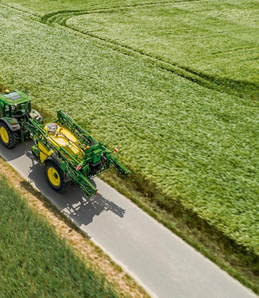
Для более быстрого движения по дороге необходима надежная устойчивость. Поэтому мы разработали модель R700i с низким центром тяжести, установив бак еще ниже в прочное, хорошо сбалансированное шасси. Теперь скорость транспортировки до 40 км/ч является безопасной, удобной и надежной.
