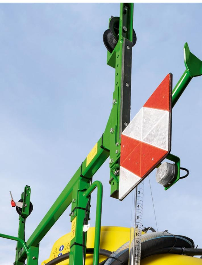
Во время транспортировки штанги подвешиваются к роликам, благодаря чему сохраняется возможность перемещения, амортизируются удары, предотвращается напряжение штанги и ее повреждение.
