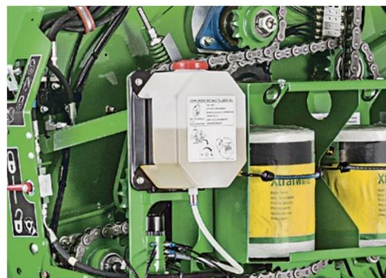
Мы сгруппировали все точки смазки в блоки для упрощения обслуживания. Автоматическая система смазки предоставляется в качестве дополнительного оборудования.
