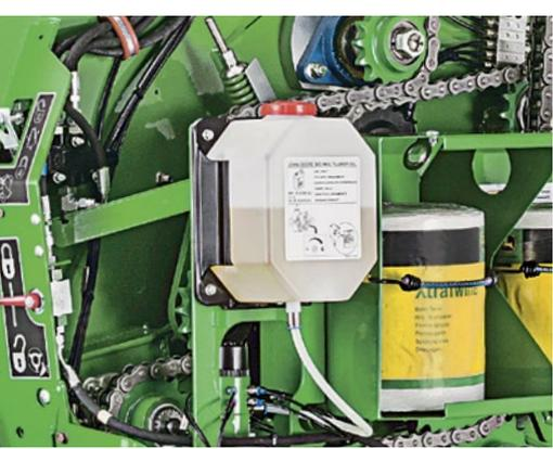
Мы сгруппировали все точки смазки в блоки для упрощения обслуживания. Автоматическая система смазки цепей предлагается в качестве дополнительного оборудования.
