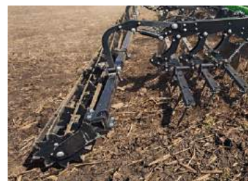
3-рядная штригельная борона с планчатым прикатывающим катком
