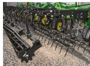
3-рядная зубовая борона с планчатым прикатывающим катком
